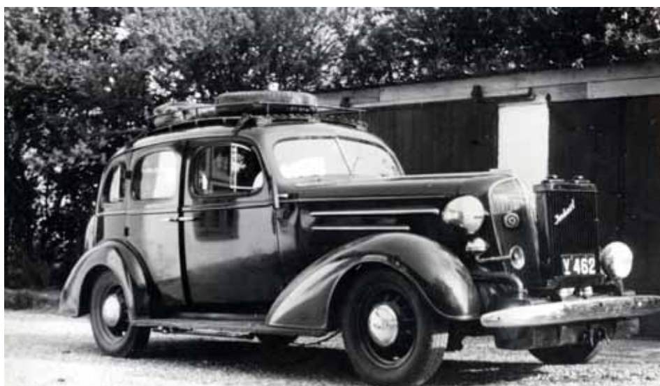
Chevrolet 1938 med generator og ekstra køler. Købt af Johannes Schmidt, som blandt andet kørte for Hvidsten-gruppen med bilen
